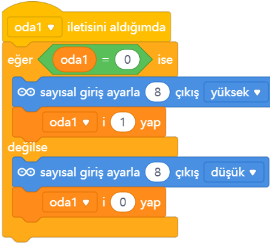
Görsel 3.78: Oda1 iletisi sarı LED kontrolü
